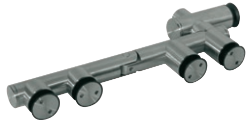
Edelstahl-Türband flächenbündig 180° mit Winkelverbinder, Glas/Glas (siehe Seiten 48+50)
